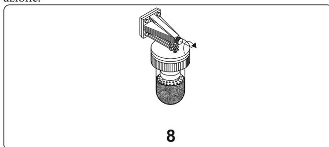
Chiudere la vite di disareazione. Il dosatore è pronto per l'esercizio.
