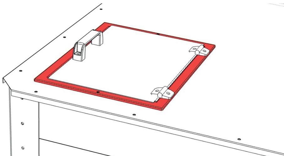
MONTARE LA GUARNIZIONE DI TENUTA COCLEA
