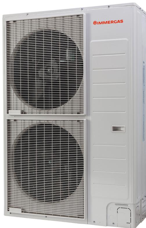
Pompe di calore ibride aria/acqua reversibili ad inverter "splittate", costituite da una unità esterna più unità interna (avente gruppo idronico e scambiatore R410A/acqua separato dell'unità esterna + unità a condensazione).
