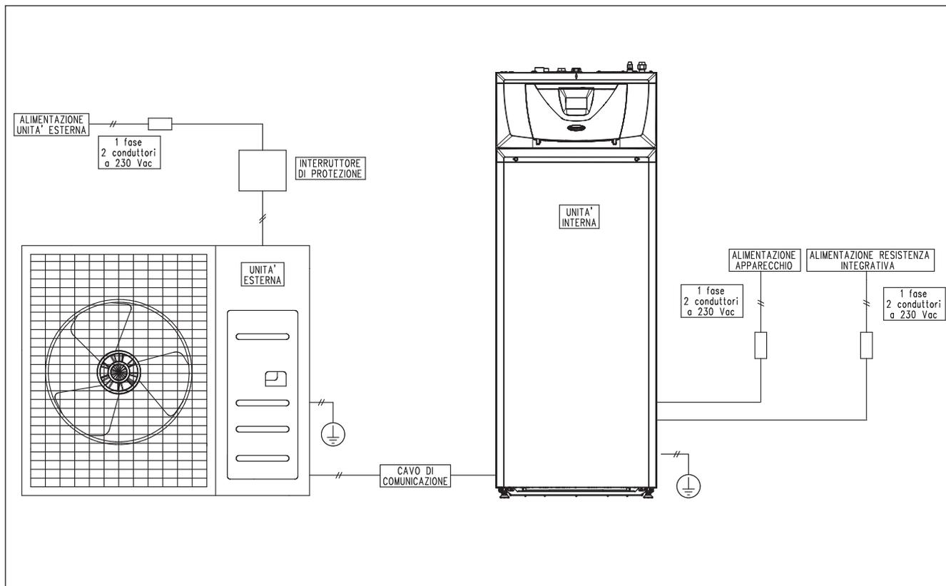
**Caratteristiche di allacciamento unità esterna.** Il cavo di alimentazione dell'unità esterna (non fornito di serie) deve essere adatto per installazione all'aperto ed avere almeno una guaina flessibile in policlorofene (codice IEC:60245IEC57 / CENELEC:H05RN-F). Indicativamente la sezione idonea del cavo può essere di 2,5 - 6 mm<sup>2</sup>, da verificare in funzione delle specifiche condizioni di installazione.
