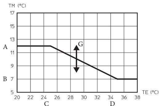
Temperatura di mandata in fase raffreddamento con modulazione sonda esterna assente
