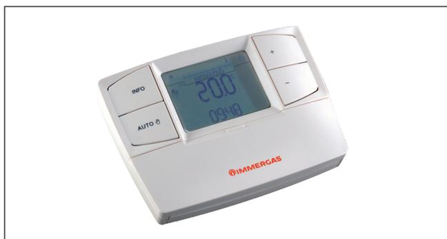
È un cronotermistato digitale retroilluminato di tipo On/Off con microprocessore, permette di impostare due livelli di temperatura ambiente, uno per il giorno (temperatura comfort) ed uno per la notte (temperatura ridotta), consente di impostare programmi settimanali differenziati di accensioni e spegnimenti; Visualizza eventuali codici di errore.
