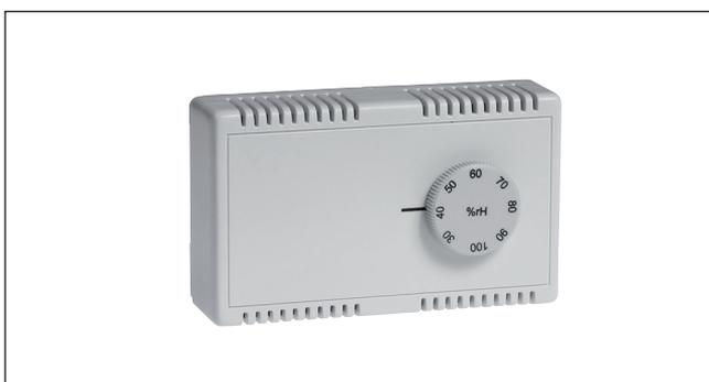
È un dispositivo che consente di controllare l'umidità in ambiente. Regolabile tramite manopola per selezionare la percentuale di umidità relativa da controllare tra il 30 e 90%, agisce con un contatto tipo On/Off per apparecchiature di deumidificazione. L'umidostato è progettato per l'installazione a parete o su scatole di derivazione normalmente in commercio. Viene collegato all'apparecchio con soli 2 fili.
