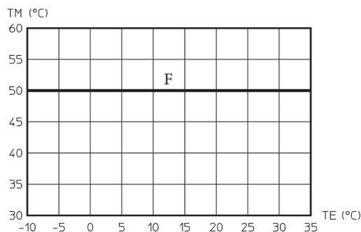
Temperatura di mandata in fase raffreddamento con modulazione sonda esterna abilitata
