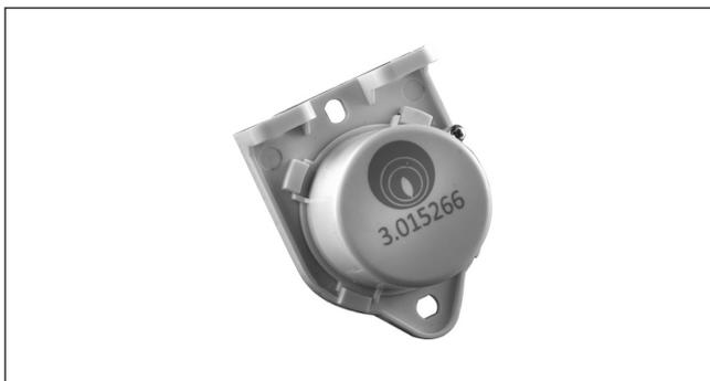
È un dispositivo che consente di adeguare il calore fornito all'impianto in funzione della variazione della temperatura esterna. La sonda esterna agisce sempre quando è collegata, indipendentemente dalla presenza e del tipo di termoregolazione. Può essere fissato in parete utilizzando le viti e tasselli in dotazione possibilmente sulla parete a Nord o Nord-Ovest. Viene collegata con soli 2 fili, con lunghezza massima di 50 metri.
