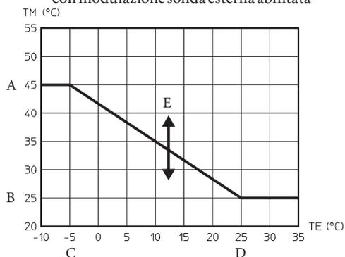
Temperatura di mandata in fase riscaldamento con modulazione sonda esterna assente
