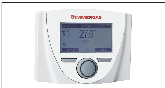
È un dispositivo elettronico dotato di display retroilluminato, per il controllo e la regolazione della temperatura e dell'umidità dell'ambiente. Il collegamento alla morsettiera avviene tramite due cavi BUS e due cavi per l'alimentazione.
