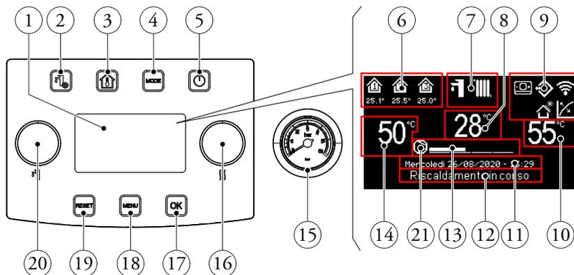
Mediante l'impostazione dei parametri nel menù "Termoregolazione" è possibile regolare il modo di funzionamento del sistema.
